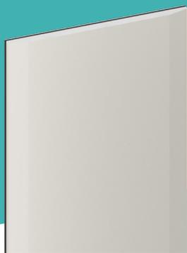
Lastra standard di tipo A (EN 520) rivestita sulla superficie non a vista con una lamina di alluminio con funzione di barriera al vapore. La lastra è impiegata nella realizzazione di pareti, contropareti e controsoffitti dove è richiesta una correzione della diffusione del vapore derivante da analisi termo-igrometrica.
